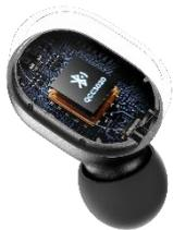
QCC3020 SoC 搭載 φ7.2mm ダイナミックドライバー
