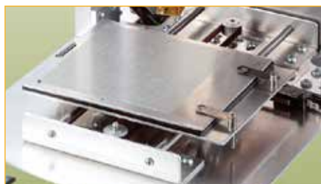
造形物固定用の定着シートを装着した成形テーブル
