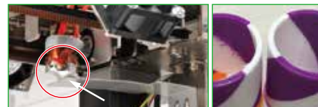
待機中のヘッドノズル(赤い円)を塞ぐシャッター(白矢印)の働きにより、つなぎ目のゴミの付着が低減している(写真右)。
