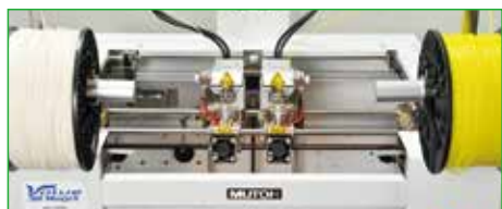
ボディ上部に搭載されたMUTOH自社開発 高速デュアルヘッド。
