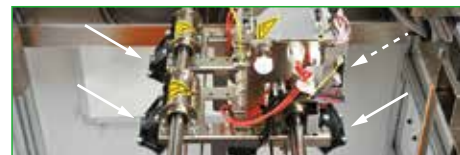
ヘッド前後に2個ずつ搭載された冷却ファン(白矢印)
